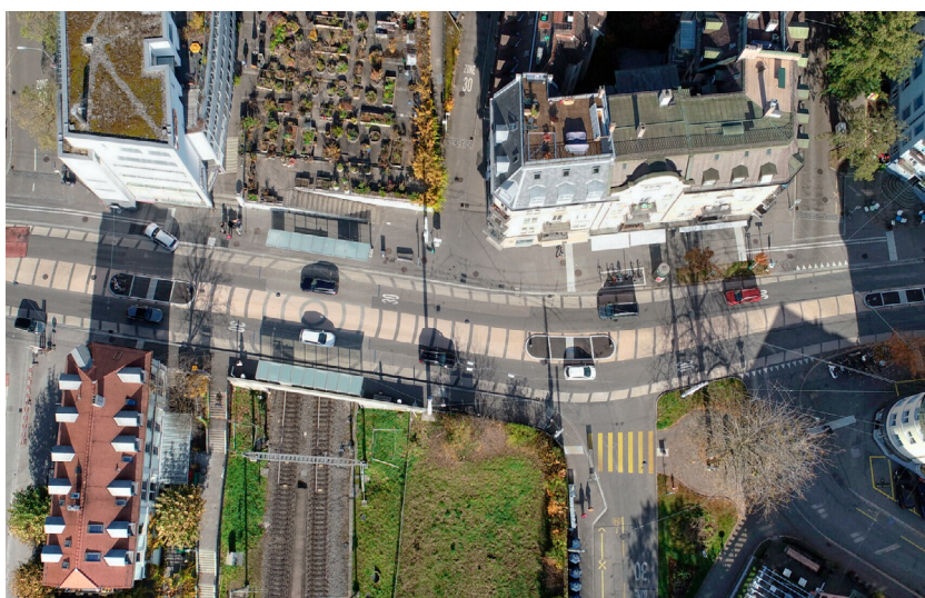
Les bandes médianes polyvalentes n'ont de sens que là où l'on peut effectivement traverser sur toute la surface. Pour les personnes avec un handicap visuel, des aides ponctuelles à la traversée restent cependant nécessaires.
